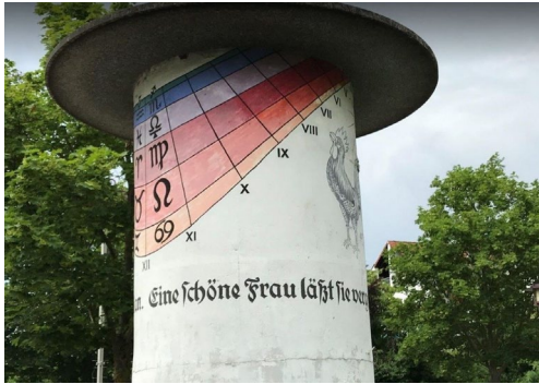
Figura 12b - Detalle del sombrero, las líneas horarias y las líneas de calendario del reloj de sol sobre columna publicitaria de Pleidelsheim (Alemania) (Fotografía: https://www.pleidelsheim.de/freizeit-kultur-tourismus/pleidelsheim-entdecken/kunst )
