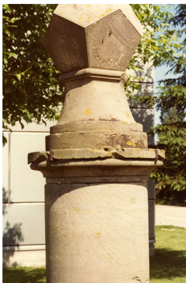
Figura 2b - Detalle de los restos del "sombbrero filtrante" y de las líneas horarias y de calendario del reloj de sol de Lorquin (Francia) (Fotografía: Serge Gregori. Inventaires des cadrans solaires 2020. SAF-CCS)
