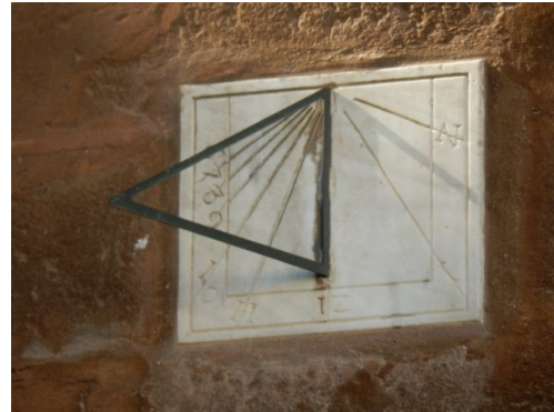
Fig. 11. Reloj solar declinante a levante situado en el muro exterior de la Capilla Real de la Catedral de Sevilla.
