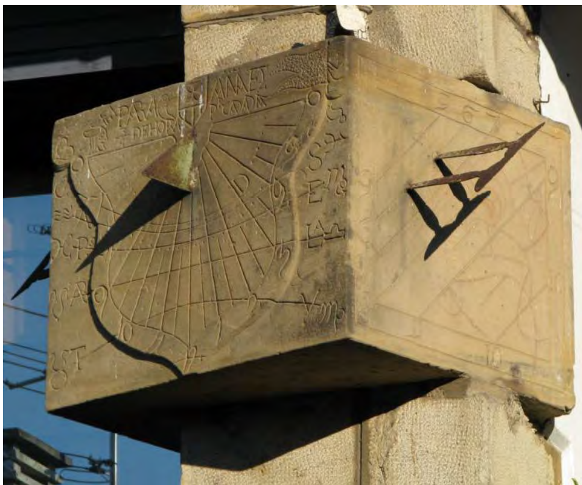
Reloj de Gijón. "PARA (luna en menguante) AÑADE \frac{3}{4} DE HORA PR CADA DIA"
