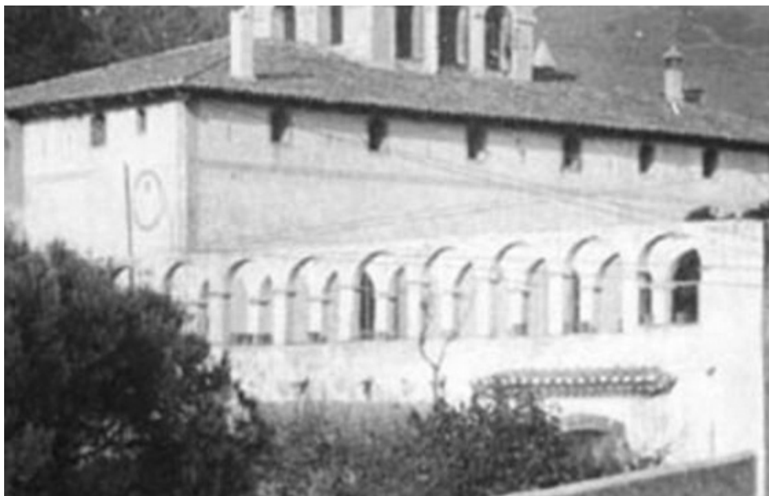
Reloj doble. Cuadrante vertical declinante a poniente. Ovalado. Varilla de un apoyo.
