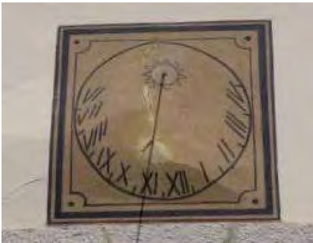
Circular inscrito en un cuadrado. Sol decorando el polo. VDL Horas en números romanos de VI de la mañana a IV de la tarde. Varilla de un apoyo.
