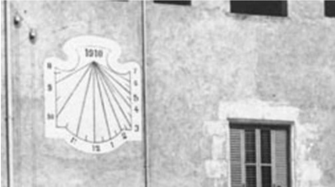
Forma de escudo. Vertical declinante a poniente. Horas en números arábigos, de 8 de la mañana a 7 de la tarde. Varilla de un apoyo. Inscripción de fecha: 1910.
