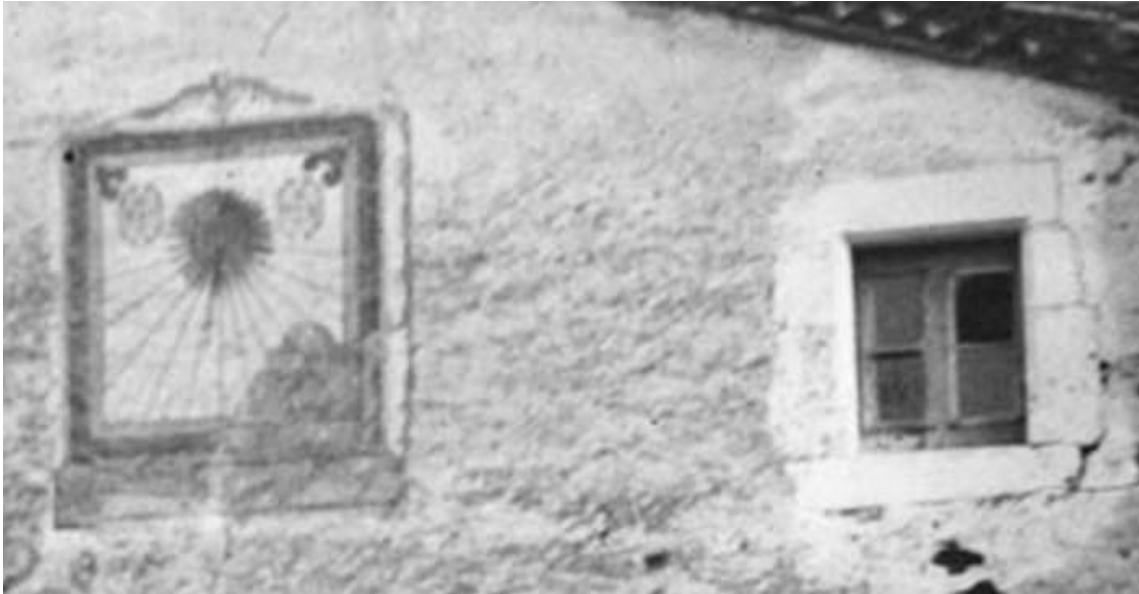
Rectangular con basa, adornos en el remate y en los espacios libres que deja la traza. Sol radiante decorando el polo. Líneas de medias horas. VDP. Varilla de un apoyo.
