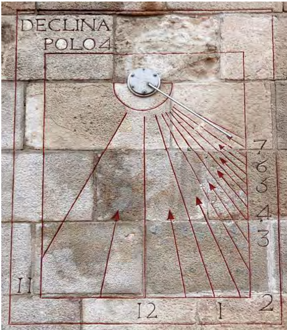
Reloj 2. Rectangular vertical. Vertical declinante a poniente.
